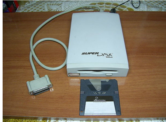
Unidad SuperDisk externa con puerto paralelo y disquete LS 120.
