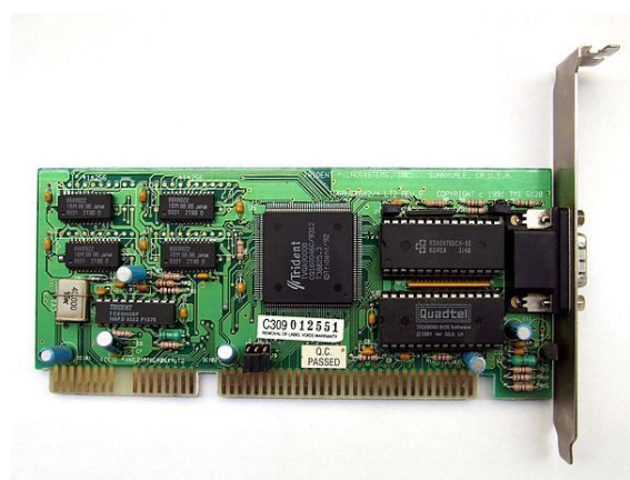
La BIOS de vídeo es visible como un integrado separado
